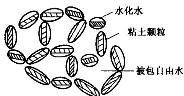
图 1-2 粘土颗粒间形成的空间网状结构
