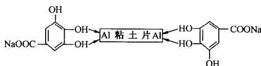
图 1-3 五倍子酸钠在粘土颗粒断键边缘的吸附
