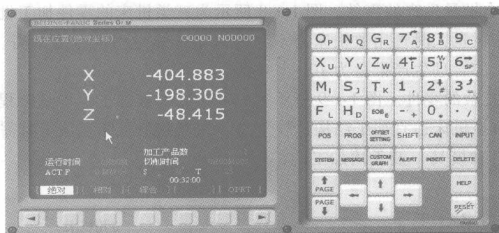
图 1-2-1 FANUC（法那克）Oi-MB 数控操作面板
