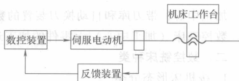
图 1-1-6 半闭环控制系统框图
