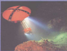
具有双向信息交互功能的 DEPTHX 机器人,该机器人拥有 100 多个传感器、36 台自带计算机和 16 个推进器,用于探测墨西哥无底洞。
