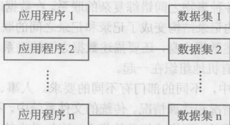
图 1-1 人工管理阶段应用程序与数据之间的对应关系
