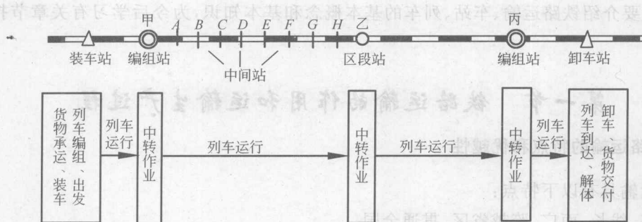
图 1-1 铁路整车货物运输生产过程示意图
