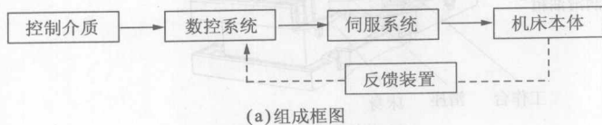
图 0.1 数控机床的组成
