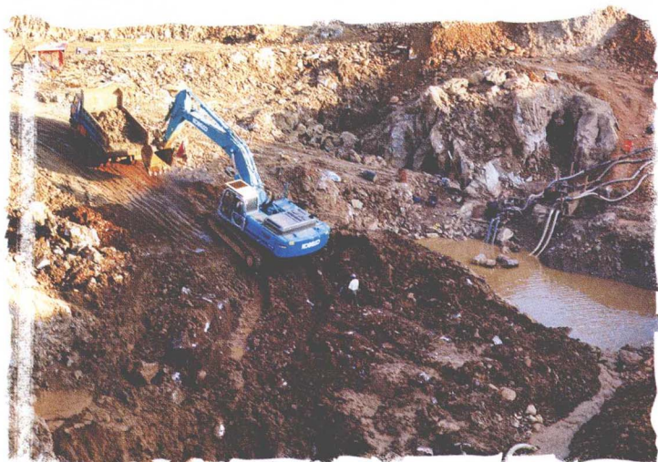
挖取翡翠时，一边是挖掘机取出土石，一边是抽水机抽出坑中积水
