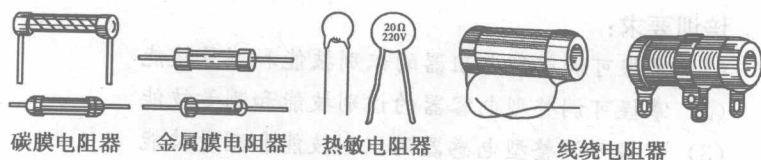
图2—1 各种电阻器外形示意图
