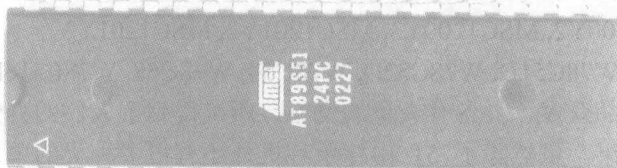
图 1-3 51 单片机的 PDIP 封装外形
