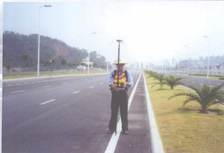
各单位将高新技术投入公路普查实际工作 图为福建省普查工作人员在进行GPS测量
