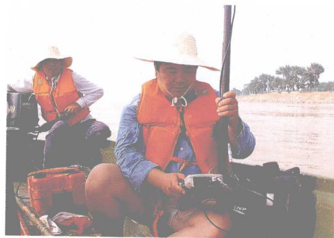
GPS全球定位系统用于水沙测验及淤积断面测量 (龙虎 摄)
