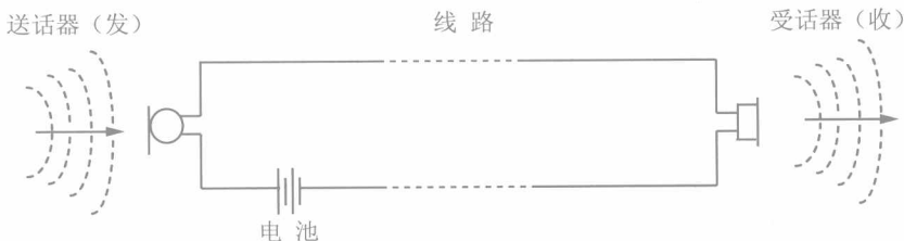
图 1-1 电话通信最简示意图
