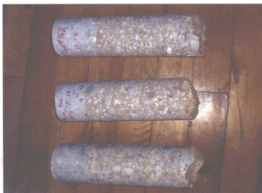
(十七) 昆明市双哨公路复合式碾压混凝土芯样
