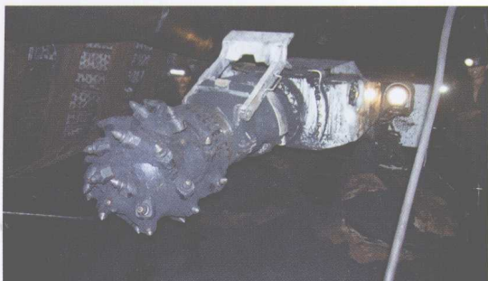
综合机械化掘进工作面
