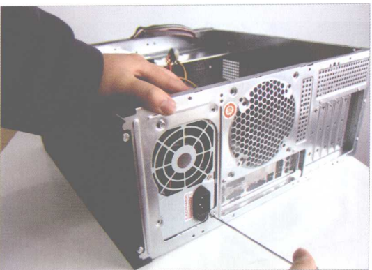
◆ 再拧入对角的螺丝钉。这样的顺序以便固定电源，方便安装
