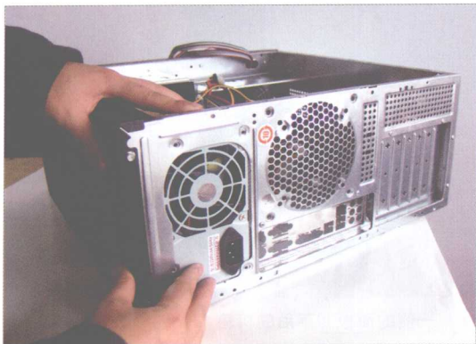
◆ 将电源上的 4 个螺丝孔对准机箱上的螺丝孔位置
