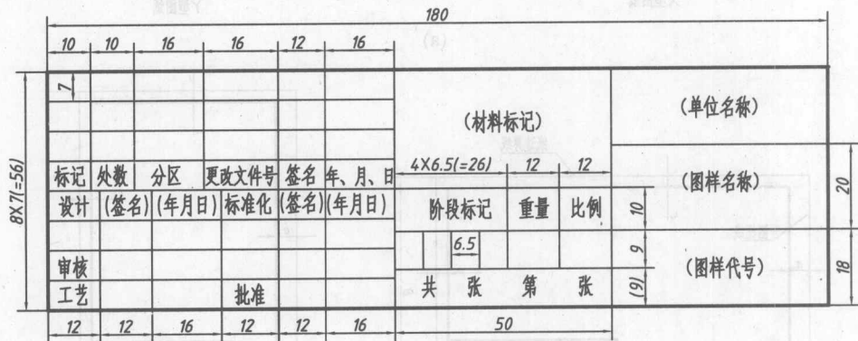
图 1.5 标题栏的格式、分栏及各部分尺寸
