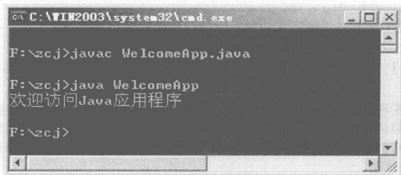
图 1-3 在 Windows 的 DOS 命令窗口下 Java 程序的编译和运行
