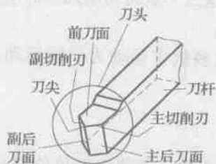
图1—3 车刀切削部分的组成
