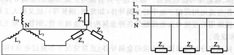
图 1.3 三相四线制交流电源与三相负载 Y_N 连接
