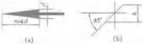
图 1.12 尺寸线终端的画法
