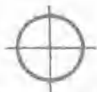
图 1.10 小圆中心线用细实线画出
