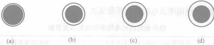
图 1-1 铝包钢单丝的铝层厚度示意图
