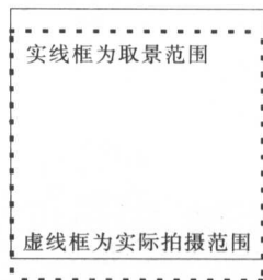
图 1-8c 双反照相机的取景和拍摄范围
