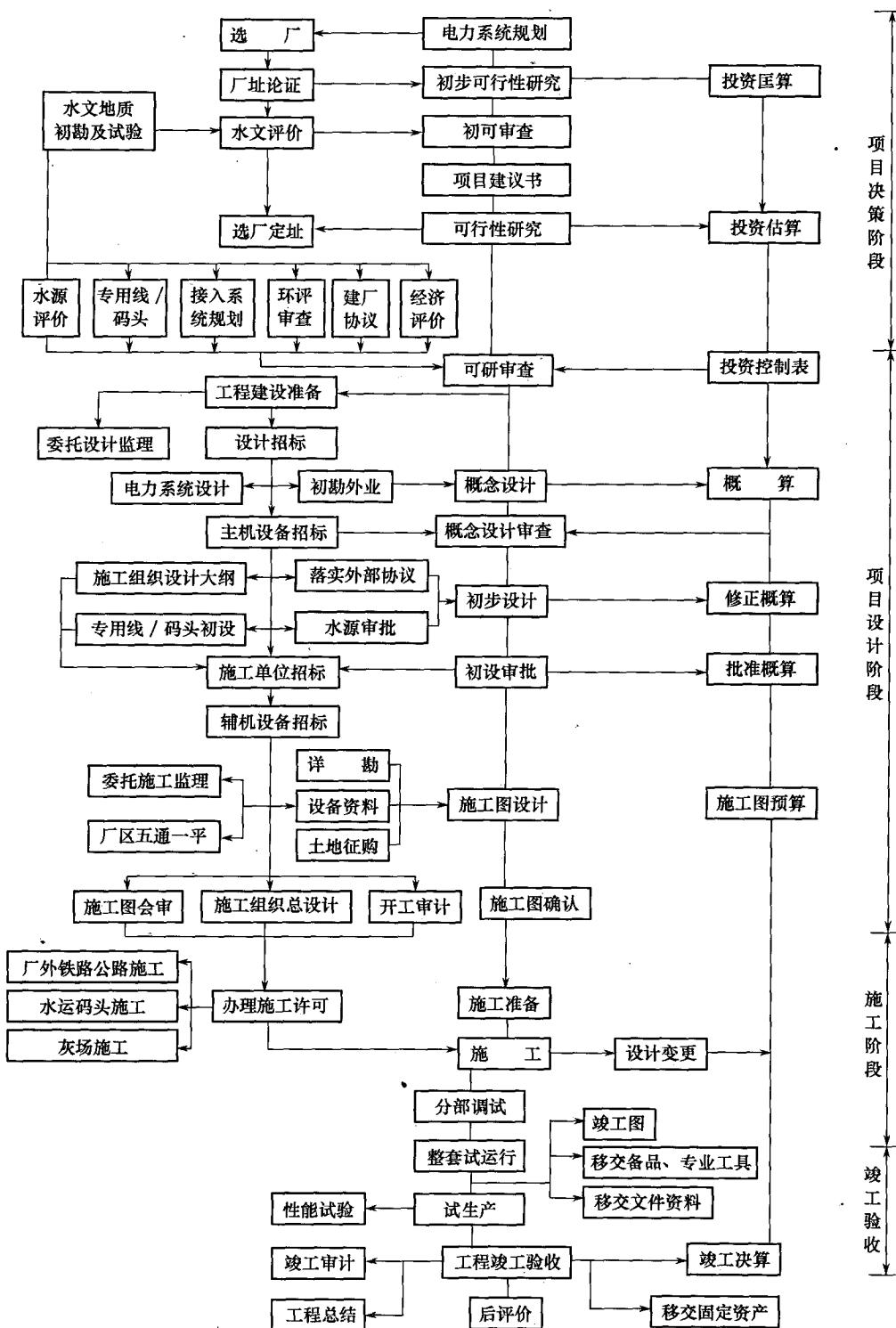
图 1-1 电力工程项目建设程序和阶段划分
