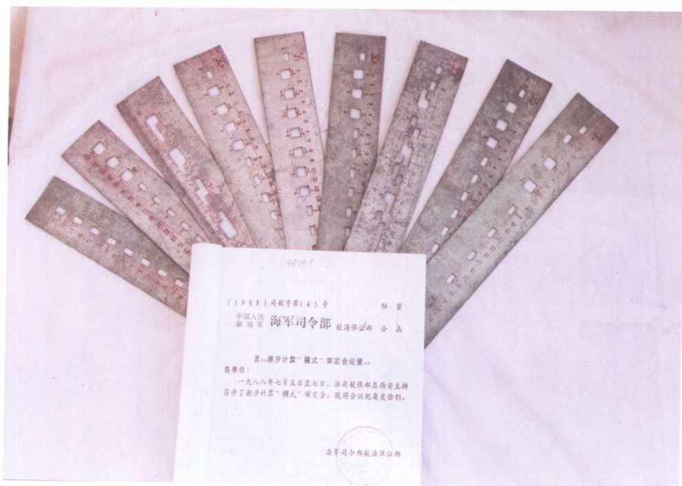
1959年国内首次用手摇计算器分析计算出60个分潮时自制的9片铁质镂空格
