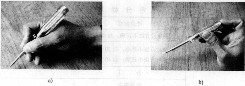
图 1—2—2 低压验电器的使用
