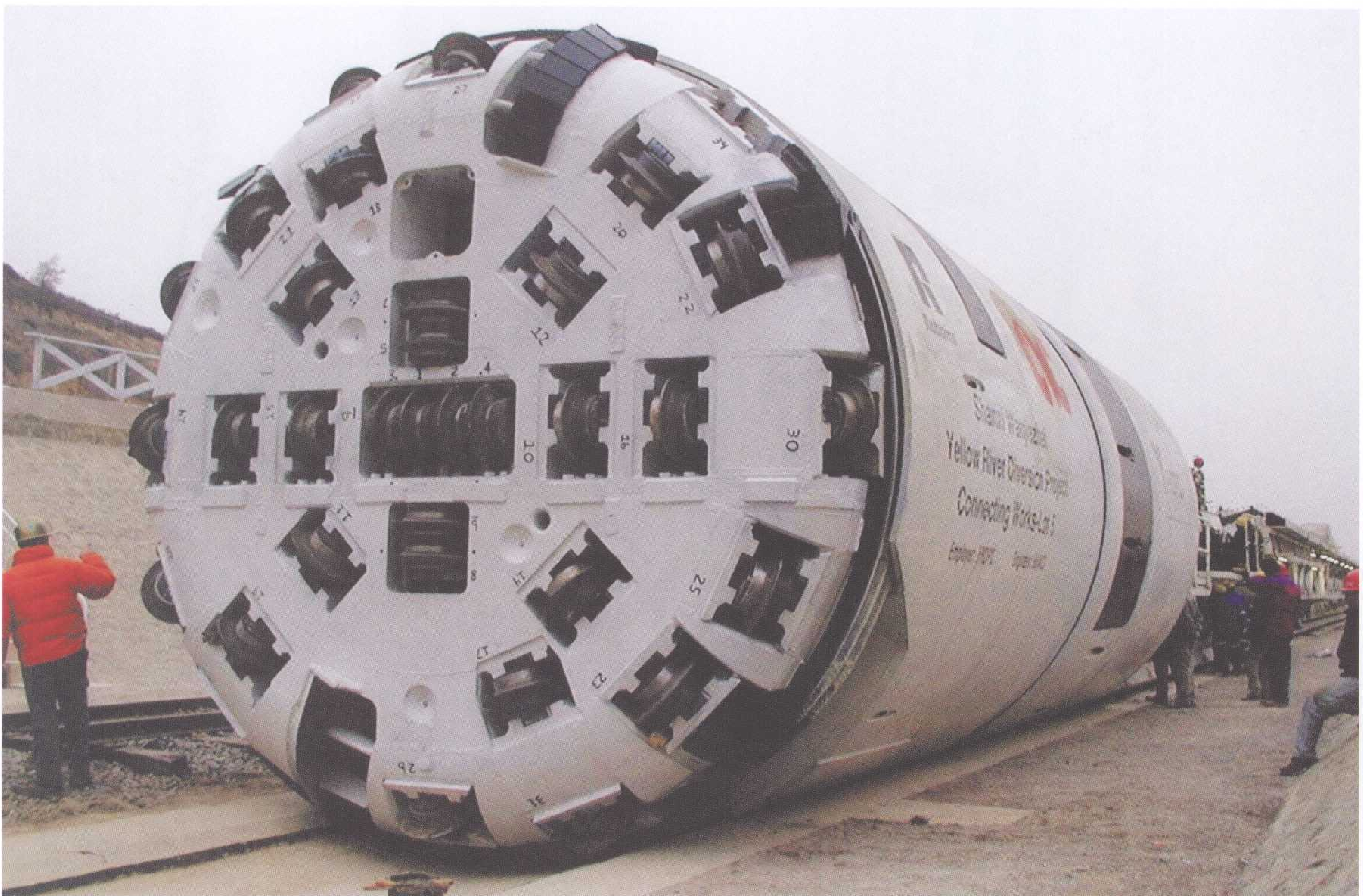
11. 罗宾斯 155-274 型双护盾掘进机，刀盘直径 4.82m, 2000 年在引黄入晋第 5 标工地组装
