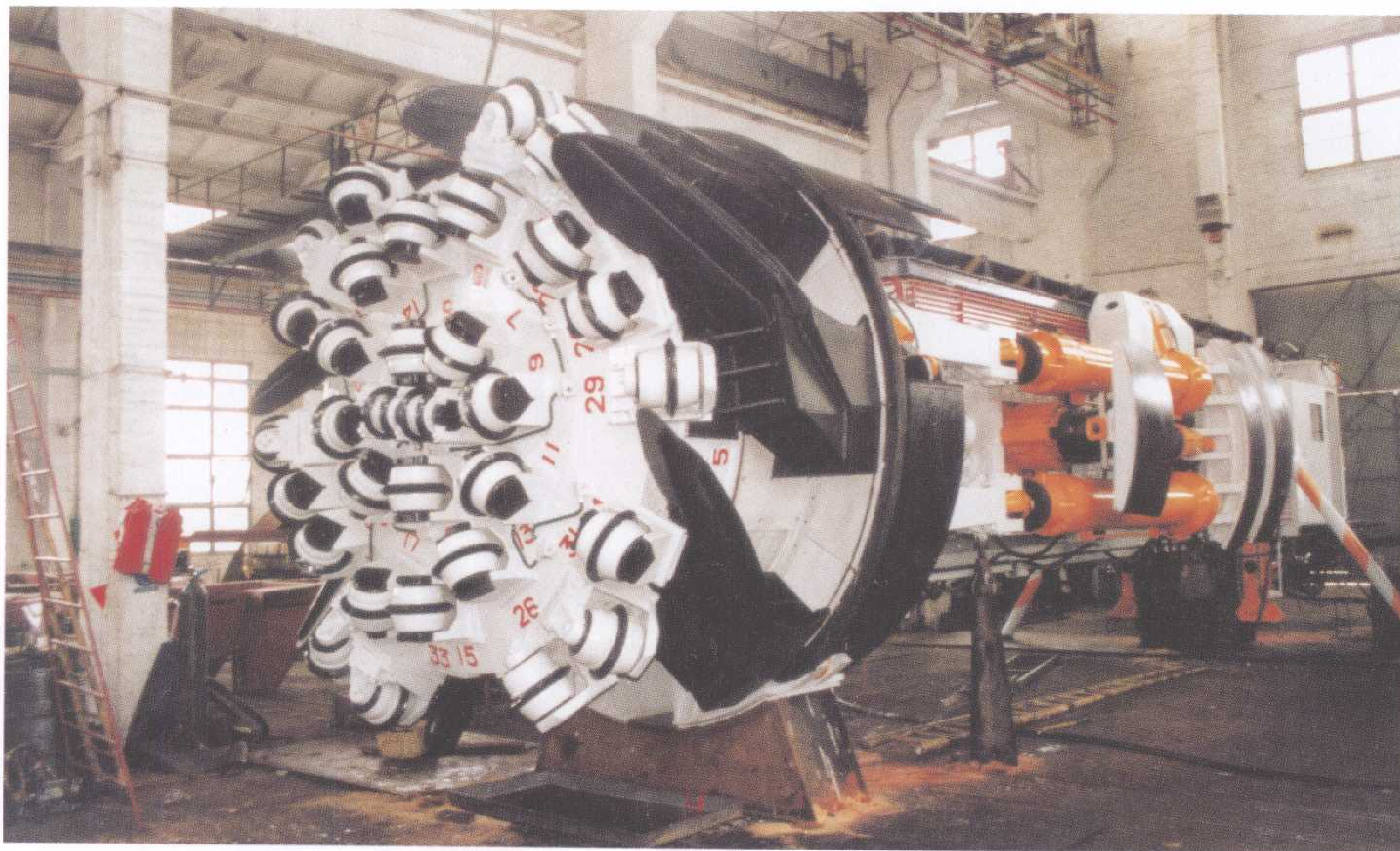
5. SJ40/45 型 支撑式掘进机，刀盘直径 4.0m/4.5m，由原水电部杭州机械设计研究所、原水电部上海水工机械厂共同研制，1990—1991 年用于福建龙门滩水电工程
