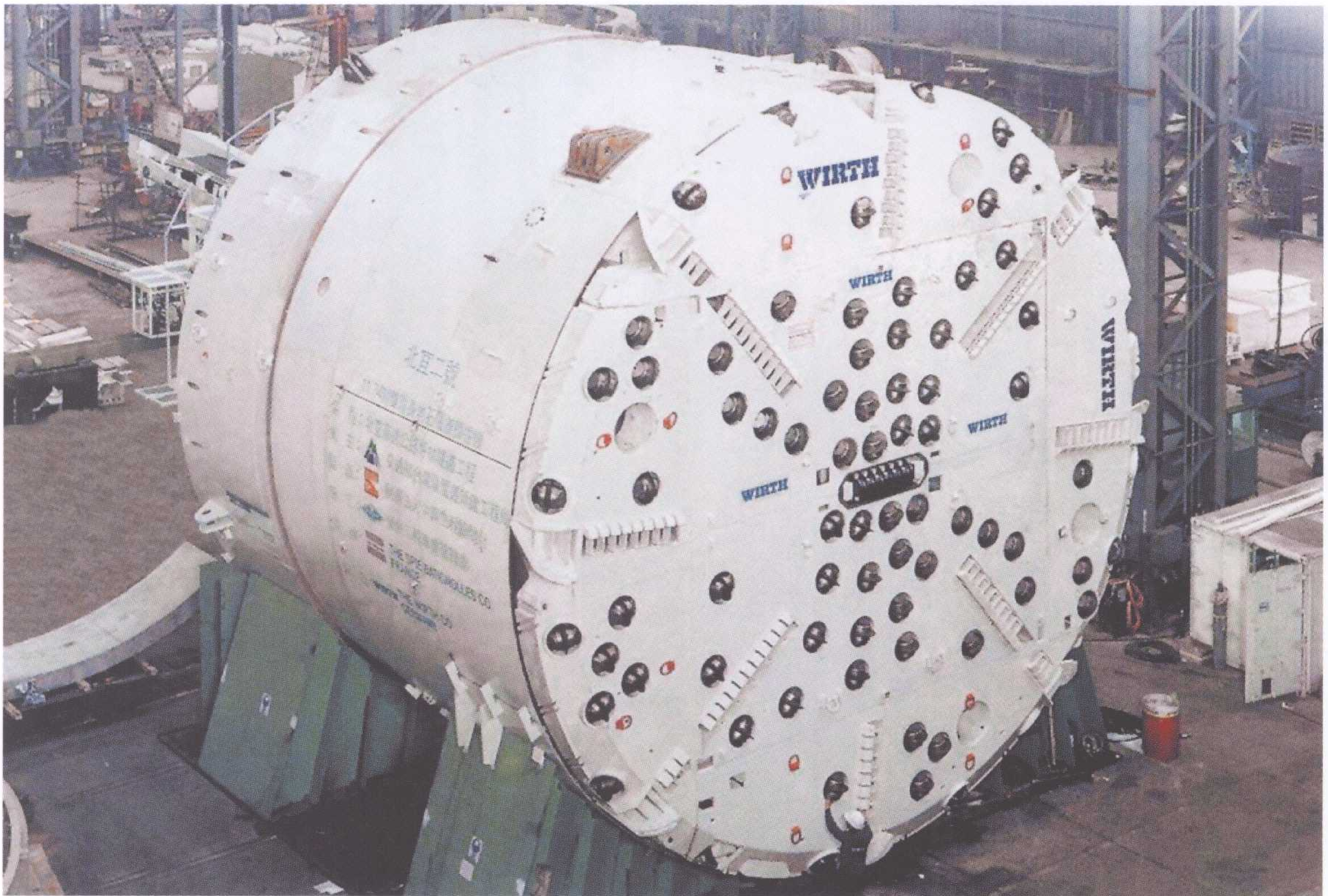
10. 维尔特 TB1172H/TS 型双护盾掘进机，刀盘直径 11.72m, 1996 年用于台湾坪林公路隧道
