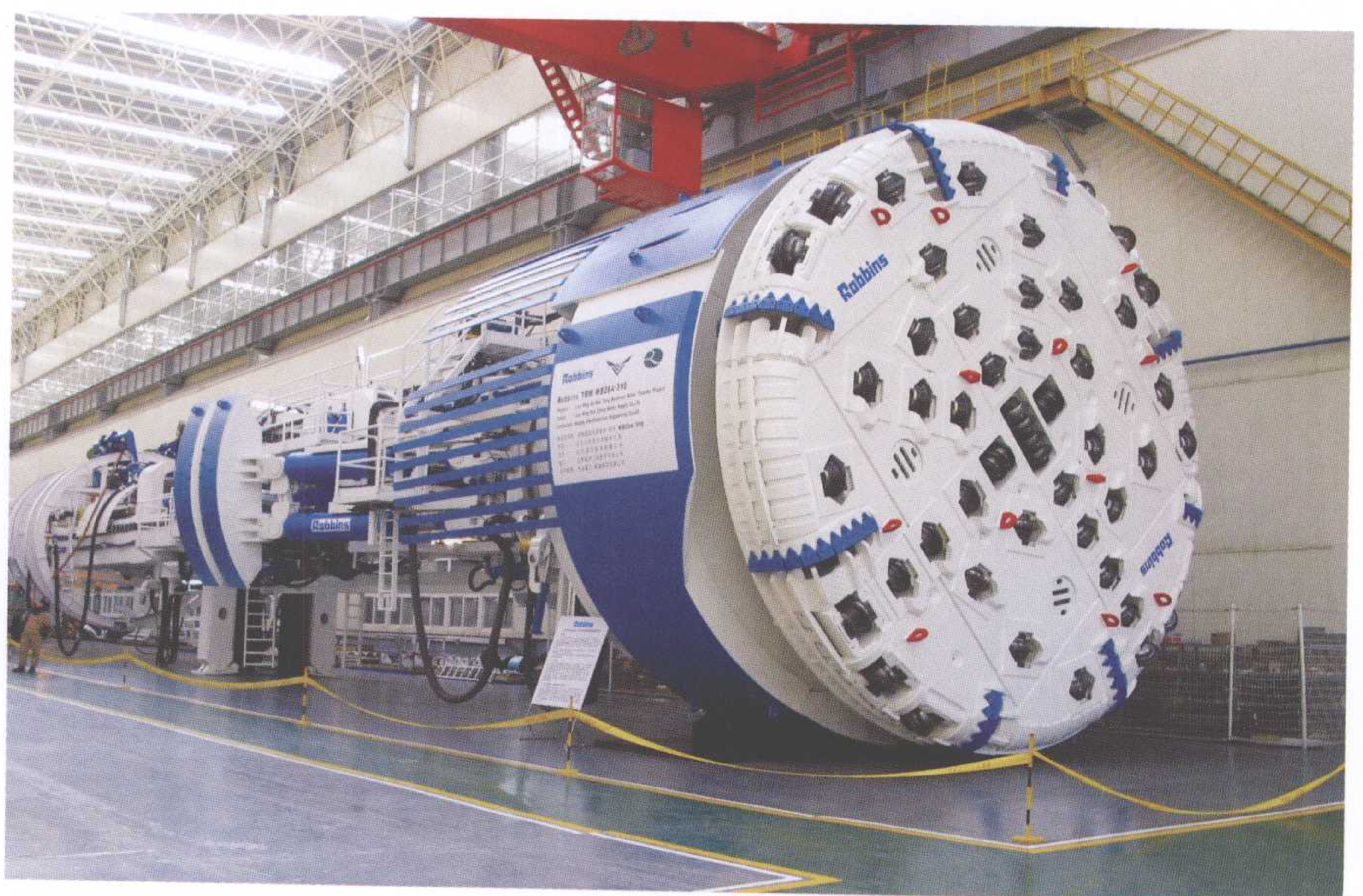
7. 罗宾斯 MB264—310 型支撑式掘进机，刀盘直径 8.03m，在大重大起集团公司组装，2005 年用于辽宁大伙房引水隧洞
