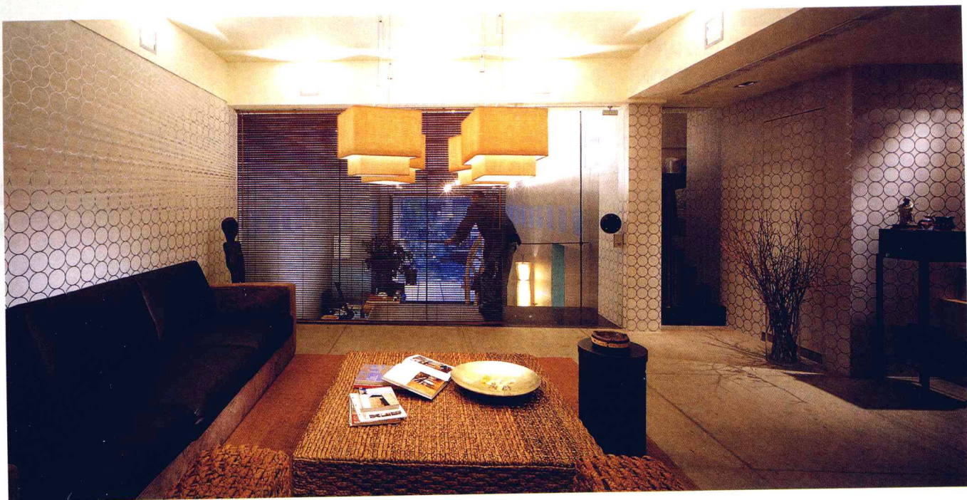
天花：轻钢龙骨纸面石膏板吊顶 60 元 / m 2 墙面：日本墙纸 27 元 / m 2 灯具：纸灯 278 元 / 盏
