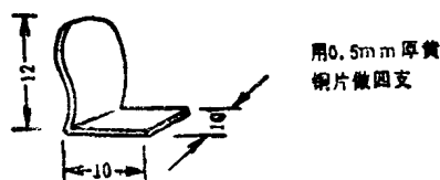
图 1-8 电池卡子的形状和尺寸
