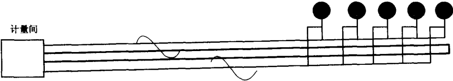
图 1-2 “一丛四管”伴热流程
