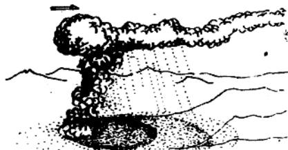
图 2-6 放射性沾染形成示意图(箭头表示风向)
