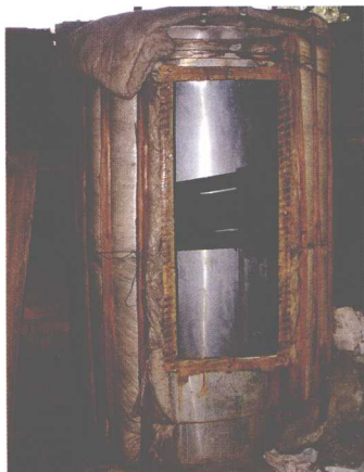
图2-7 用铝板焊制的仓式简易灭菌锅
