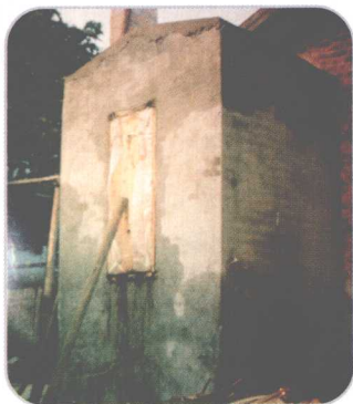
图2-6 用砖和水泥砌成的方形灭菌炉
