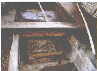
图 2-12 钢板锅式灭菌灶(烧煤)
