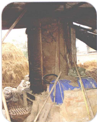
图2-8 用铝板焊制的仓式简易灭菌锅(外用保温材料)
