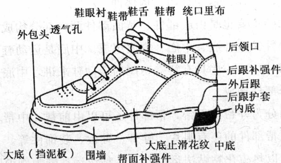
图 1-1-3 冷粘法皮革面运动鞋的结构
