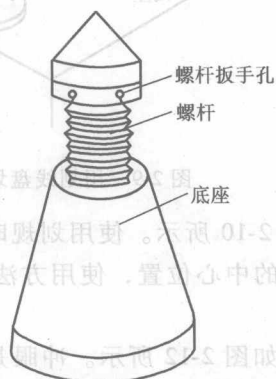
图 2-4 千斤顶 图 2-5 用千斤顶支承工件
