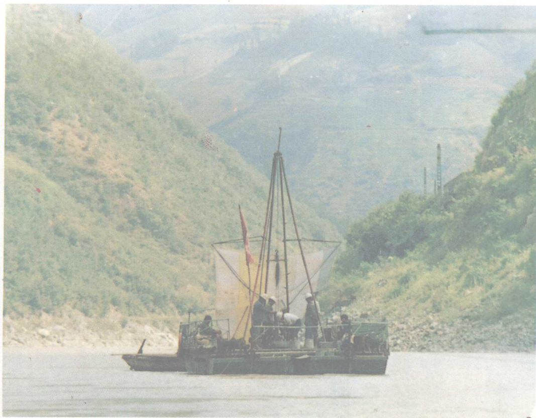
水上钻探平台在勘查砂金矿
