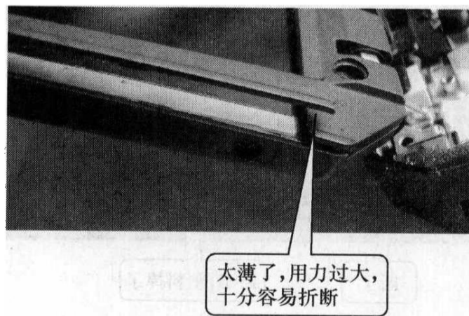
图 1-4 塑料配件太薄很容易损坏
