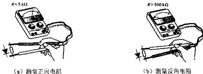
图 1-5 晶体二极管的测量
