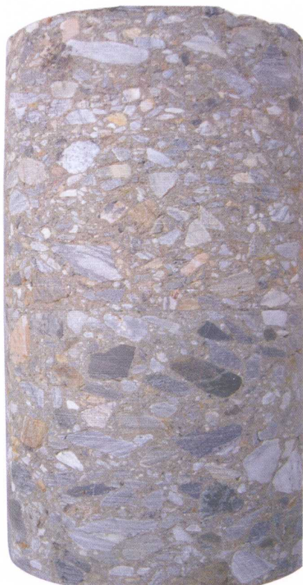
全厚式施工取芯照片
