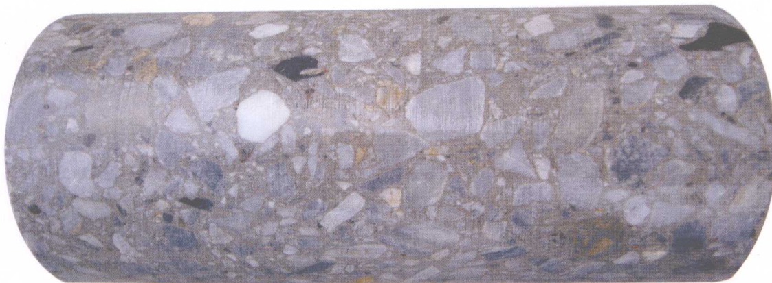
骨架密实结构水泥稳定碎石基层芯样
