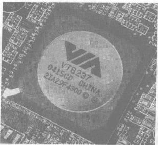
南桥芯片负责 I/O 总线之间的通信，如 PCI 总线、USB、LAN、ATA、SATA、音频控制器、键盘控制器、实时时钟控制器、高级电源管理等。因为这些技术一般相对来说比较稳定，所以不同芯片组中的南桥芯片有可能是相同的。
