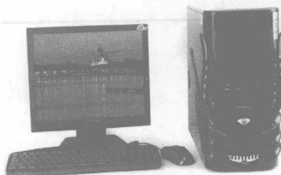
主机是电脑的核心部件，它是由主板、CPU、内存、显卡、硬盘、电源等电脑配件组成的。输入（出）设备主要指显示器、键盘、鼠标等。
