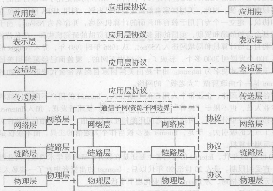
图 1.5 ISO/OSI 互连网络参考模型
