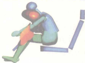
无安全带气囊的情况下， 碰撞后1/10秒时刻假人姿态
