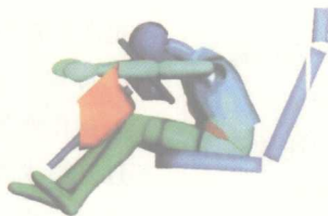
有安全带无气囊的情况下， 碰撞后1/10秒时刻假人姿态
