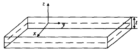
图 1-9 挠曲度分析时所采用的局部坐标系
