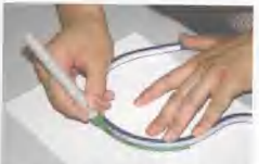
■ 将蛇尺弯曲到所需弧线用马克笔进行绘制
