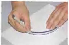
■ 将蛇尺弯曲到所需弧线用针管笔进行绘制
