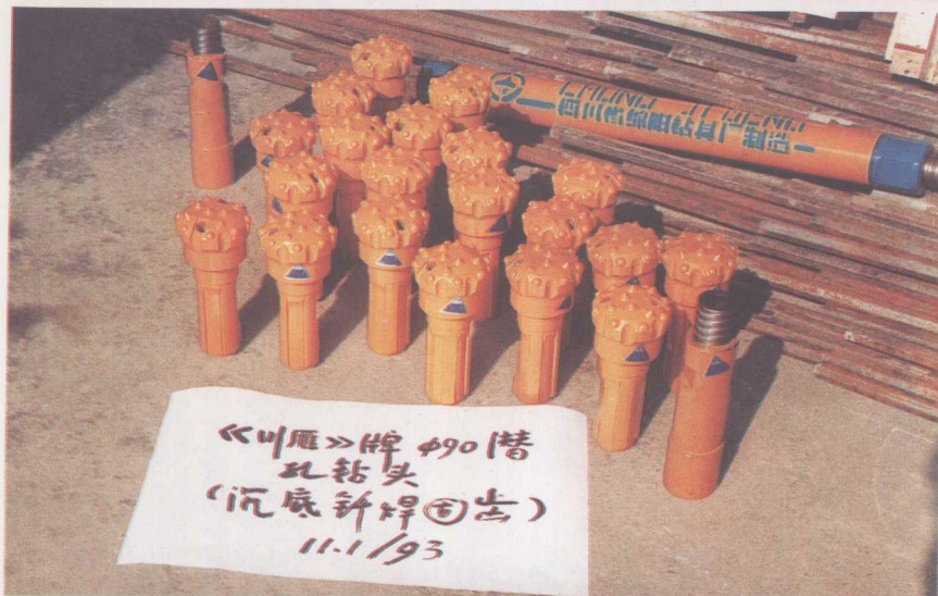
四川省绵阳市钻具厂采用低温局部沉底式感应钎焊固齿工艺生产的《川雁》牌球齿形潜孔钻头.
