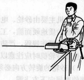
图 1—2 钳桌高度的确定
