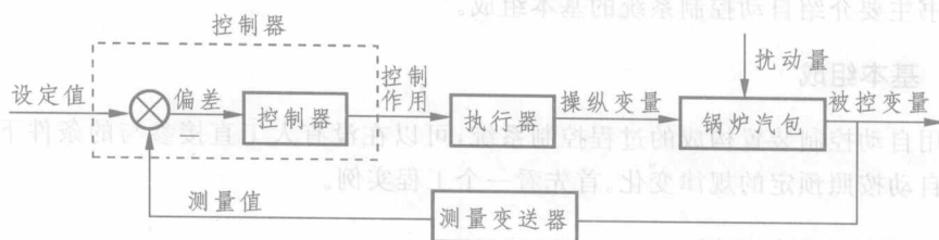
图 1-2 基本过程控制系统组成方框图
