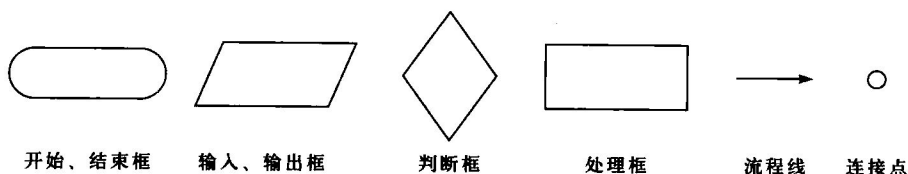
图 1-1 传统流程图的基本符号
