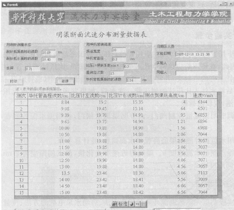
图 1-5 明渠流速测量数据表
