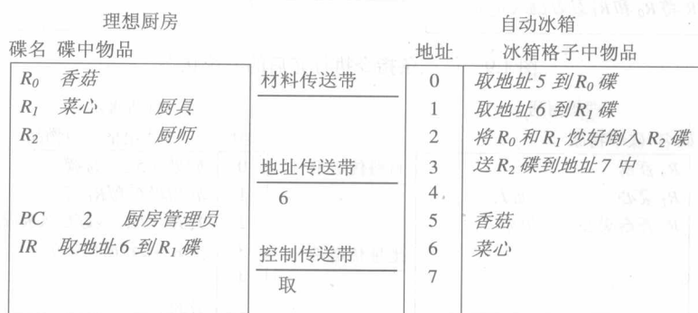
图 1.7 第二条指令取指完成后的系统状态
