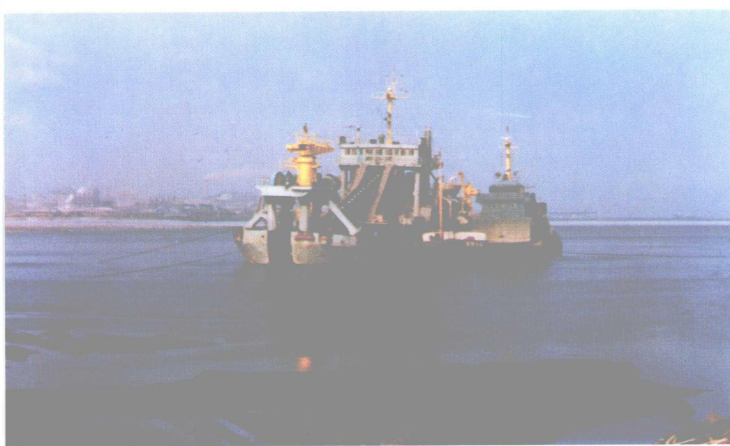
750m 3 自航链斗挖泥船——“津航浚 303”正在大连船厂大坞施工
