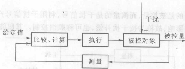
图 1-7 闭环控制框图
