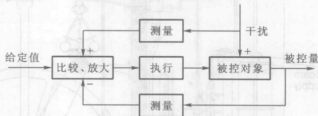
图 1-4 控制系统职能方框图
